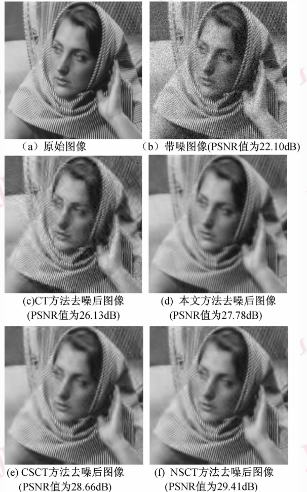
图 5 不同方法的去噪效果及去噪后图像的 PSNR
